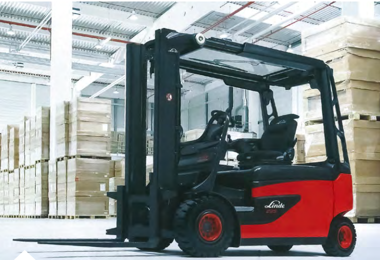
SEPTEMBER 2016 Innovation som förbättrar sikt och säkerhet Linde Roadster E25 – ett svar på förarnas önskan om ett större synfält. Utan A-stolpar och med säkerhetsglas i taket revolutionerade motvikts-trucken marknaden.
