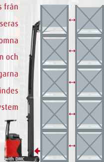
Kompensation för statisk nedböjning av stativet
