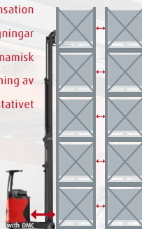
Automatisk kompensation för stativsvängningar
